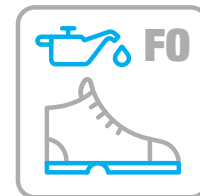
Semelle résistant aux huiles et aux hydrocarbures
